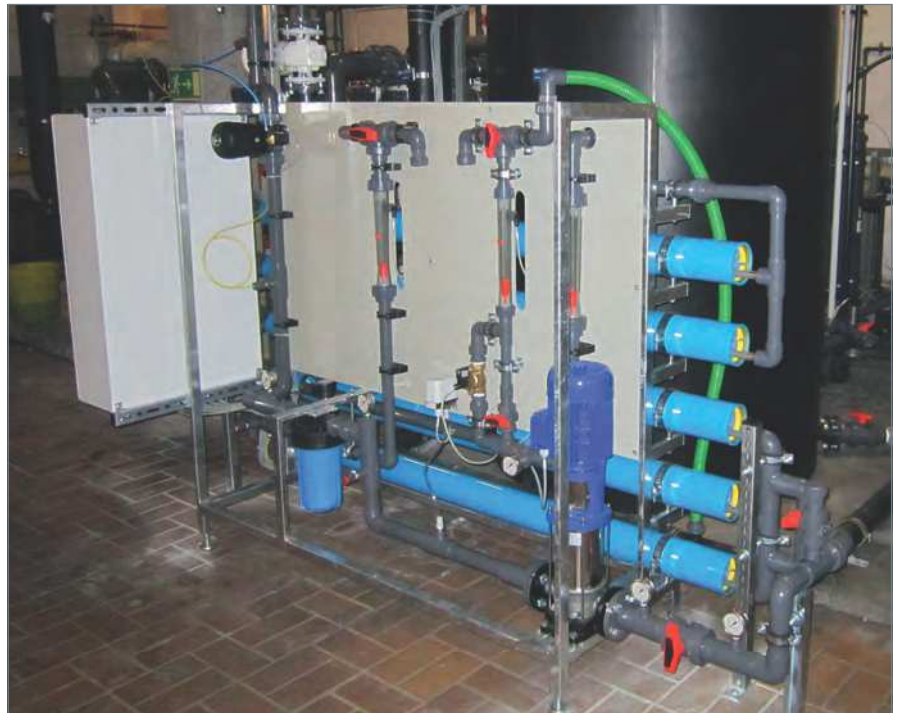
■ Abbildung 4: Pilotanlage zur Nanofiltration; Foto: W.E.T., Kasendorf
